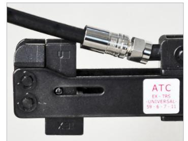
Las longitudes de compresión, calibradas en fábrica, garantizan la precisión constante.
