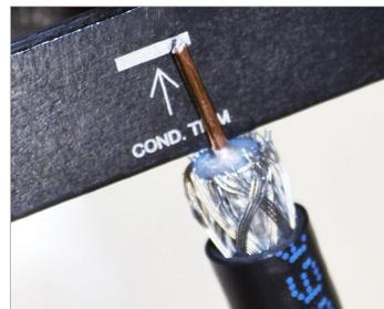
Calibrador del conductor central en el cuerpo de la herramienta, asegura la preparación correcta.
