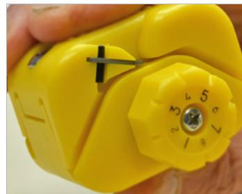
El diseño con resorte elimina la necesidad de utilizar otra herramienta para la sujeción del tubo bufer mientras este se está utilizando.
