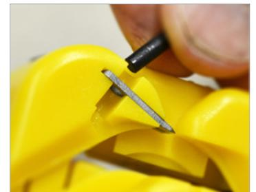
Las cuchillas de acero inoxidable no requieren ajustes y se reemplazan fácilmente.
