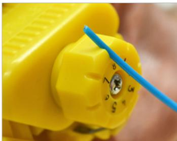
Los canales de dimensionamiento incorporados determinan el ajuste adecuado para los tubos bufer.
