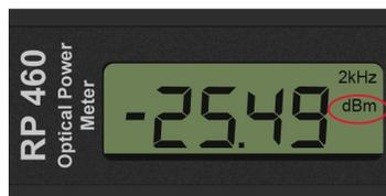
El RP 460 reconoce los «tonos» modulados de 2 kHz entrantes. El reconocimiento de tono se muestra en la pantalla y se indica mediante un pitido audible.
